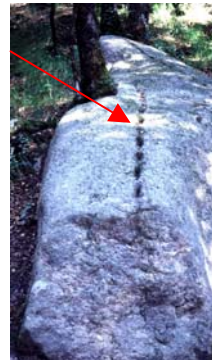
Foto: bloco de pedra com orifícios para colocar as cunhas de madeira. (CGV)
